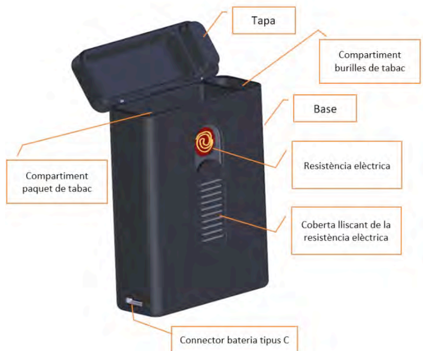
Figura 3. Prototip dissenyat amb SolidWorks i parts principals que el conformen. [Font: pròpia]
